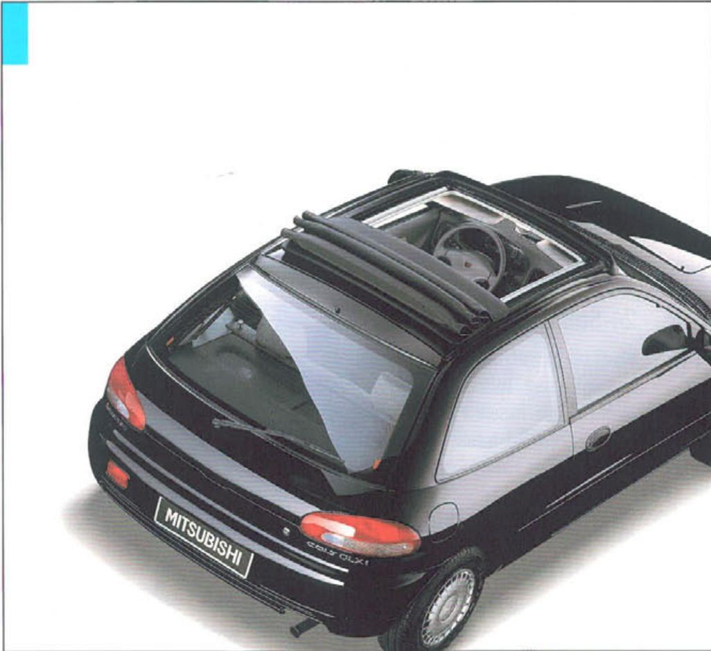
Colt 1600 GLXi mit elektrischem Faltschiebedach
