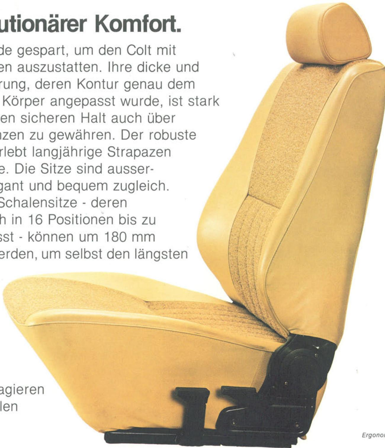
Ein Hebeldruck genügt, um die Frontsitze nach vorne umzuklappen, und so das Ein- und Aussteigen zu erleichtern. Zu den revolutionären Sitzen des Mitsubishi Colt gehören selbstverständlich auch die verstellbaren Kopfstützen.
