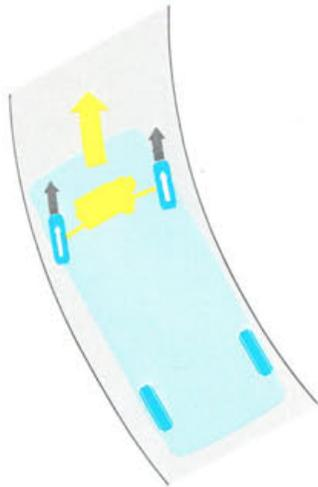
Die robuste, unabhängige Hinterachse des Colt verbessert den Komfort auf schlechten Strassen. Die U-förmigen Längslenker tragen dazu bei, die Gesamtmasse des Wagens so kompakt wie möglich zu halten. Der negative Lenkrollradius der Vorderachse verbessert die Strassenlage.
