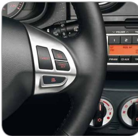
In das Lenkrad integrierte Tasten ermöglichen die Steuerung der Audio-Anlage\* und die Bedienung der Tempoautomatik\* mit nur einem Finger, sodass Sie die Straße immer im Auge behalten können.
